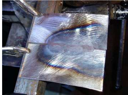
Resim 41: Oksijenle küt ek kaynağının yapılması ve kaynak dikişi
