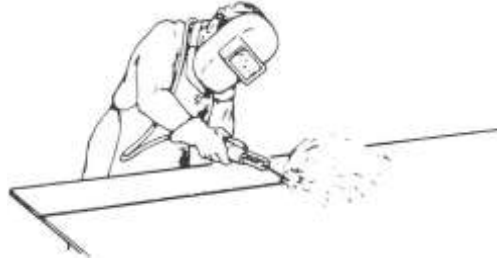
Resim 6.38: İş parçasının elektrot kullanılarak kesilmesi
