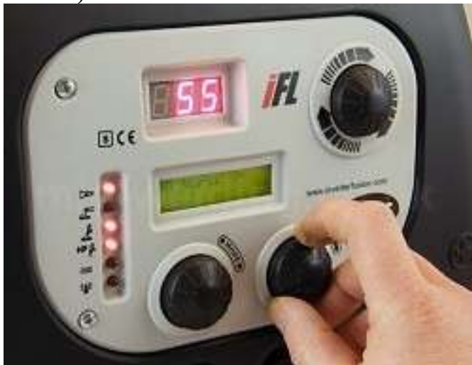
Resim 6.18: Resim 6.17'deki TIG kaynak makinesinin ayar mekanizması
