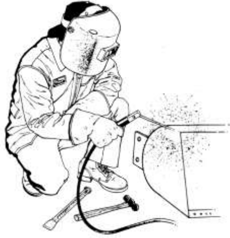
Resim 6.23: Elektrik ark kaynağı yapma
