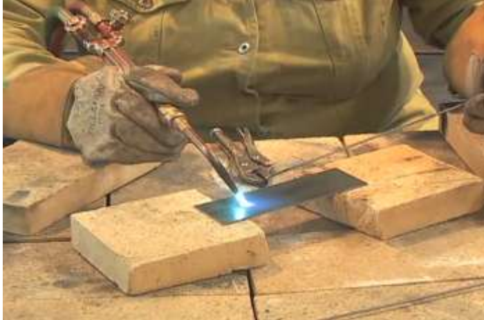
Resim 2.1: Oksijen kaynağında ek telin kullanımı
