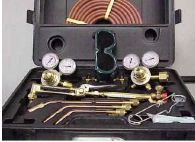
Resim 1.20: Üfleç takımı, koruyucu metal kutusu içerisinde
