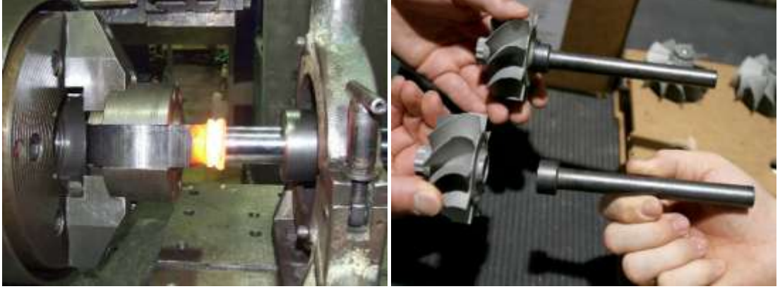
Resim 1.2: Sürtünme kaynağının yapılışı ve iş parçası
