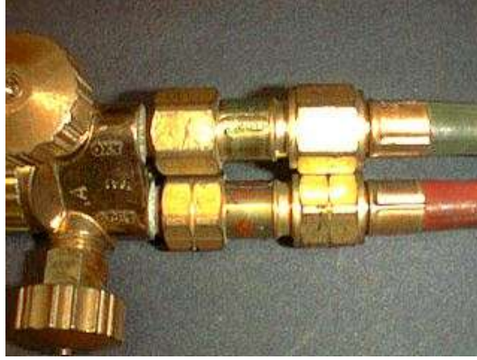
Resim 1.19: Üfleç ve hortumlar arasına bağlanmış kuru güvenlikler
