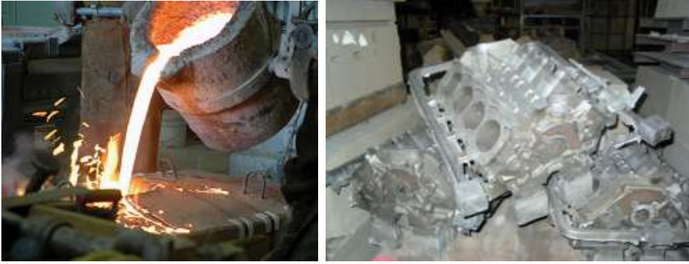
Resim 1.5: Döküm yapılışı ve döküm yoluyla biçimlendirilmiş motor gövdesi
