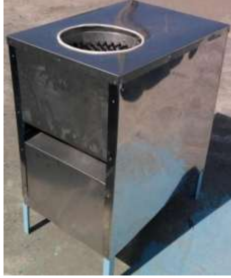
Resim 1.9: Çelik ve alaşımlarından üretilen tüy yolma makinesi
