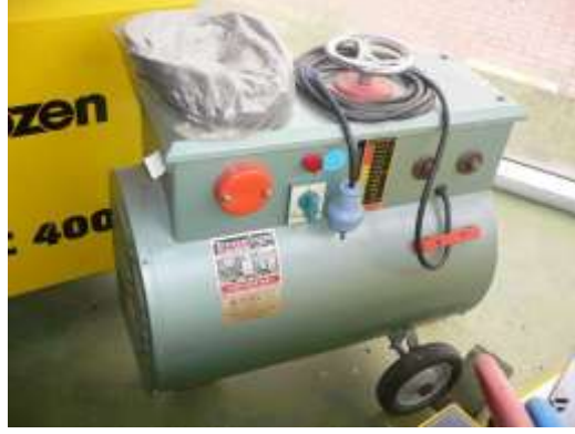
Resim 6.12: Jeneratör tipi kaynak makinesi.
