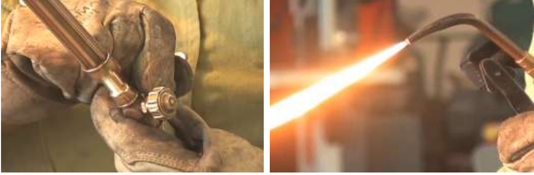
Resim 4.7: Üfleç üzerindeki valfin açılması ve alev elde etme
