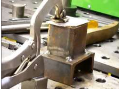
Resim 5.2: Parçaları tutturmada kullanılan C pense
