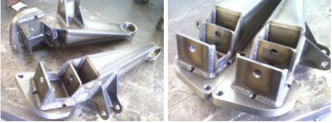
Resim 4.2: Değişik konumlar uygulanarak birleştirilmiş iş parçası
