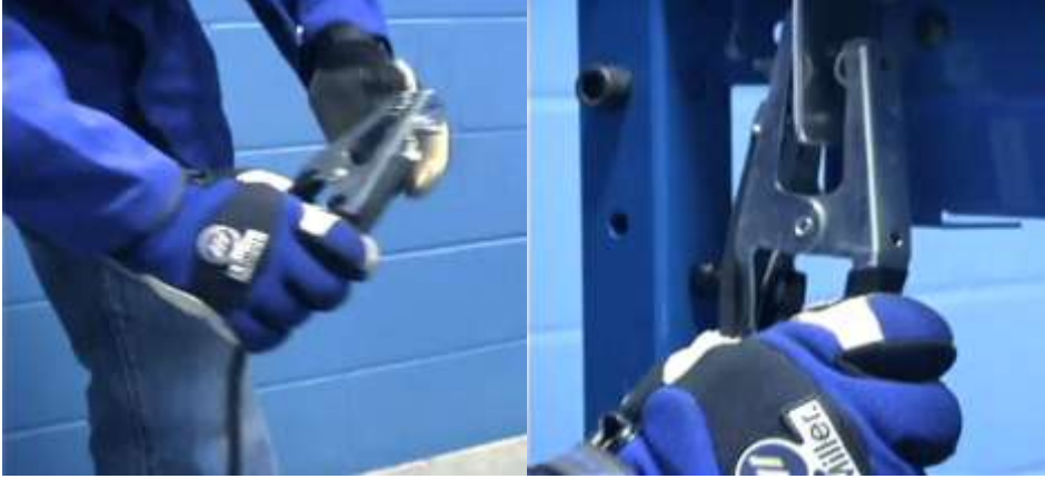
Resim 6.22: Şase ve şasenin kaynak masasına bağlanması
