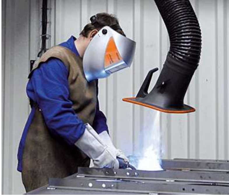
Resim 6.33: Kaynak aspiratörü ile çalışma
