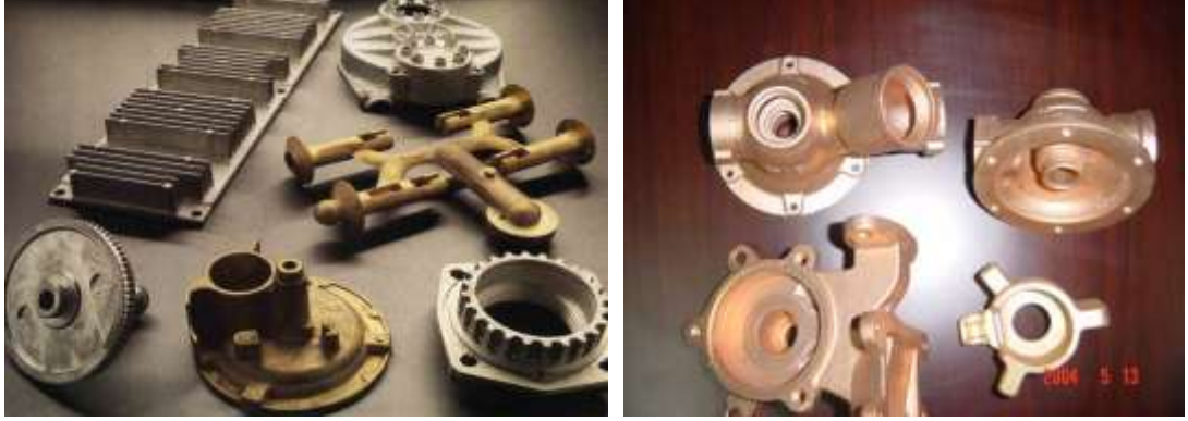
Resim 1.7: Zs<ssAlaşımlar kullanılarak üretilmiş makine parçaları
