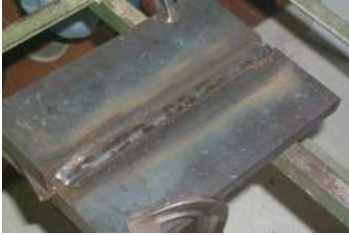
Resim 6.63: V kaynak ağzı açılıp kaynatılmış iş parçaları
