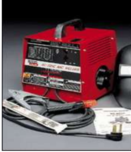
Resim 6.9: Kaynak transformatörü ve elemanları
