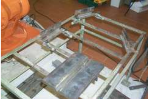
Resim 6.64: Kaynakla birleştirilmiş parçalar
