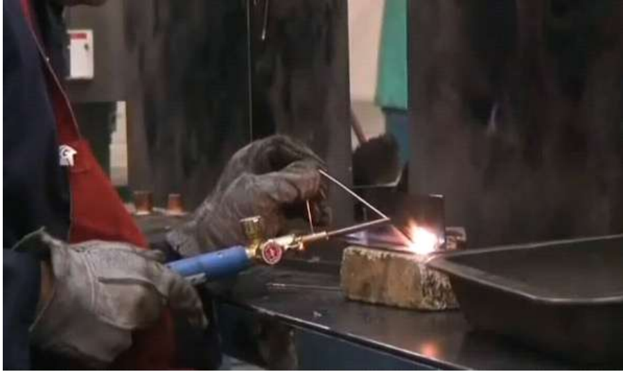
Resim 2.2: Oksijen kaynağının yapılışı
