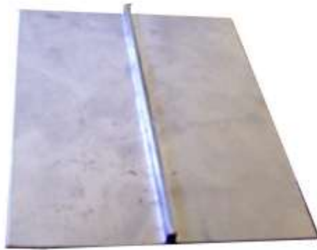
Resim 3.3: Büküntülü kaynak yapılmış iş parçası
