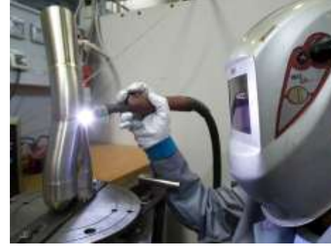
Resim 1.3: Gaz altı (TIG) kaynağının yapılışı
