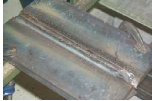
Resim 6.63: V kaynak ağzı açılıp kaynatılmış iş parçaları
