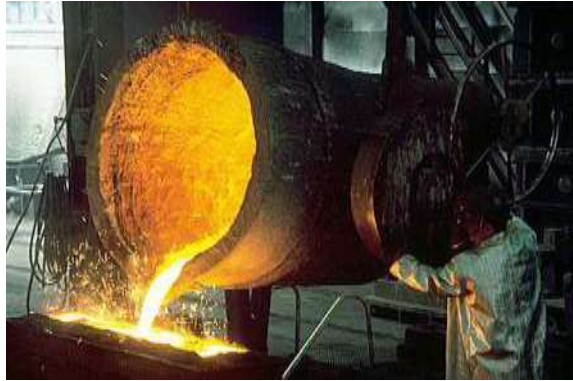
Resim 1.8: Ergiyik haldeki dökme demirin potadan kalıba boşaltılması
